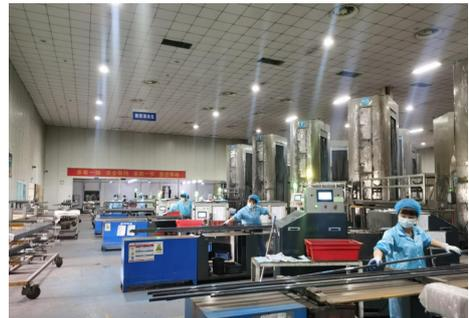
走进拉晶车间，热浪瞬间袭来，炉台加热温度最高1400多度，工人们的工作热情一点也不比炉台温度低，他们全副武装，严阵以待！操作工将拉制完成的硅芯圆棒取出，一提、一拉、一翻、一捣，硅棒安全稳妥地放入待检车辆，两名操作工配合得天衣无缝，随后检验合格的硅棒将会移交到截断岗位进行品质把关。
