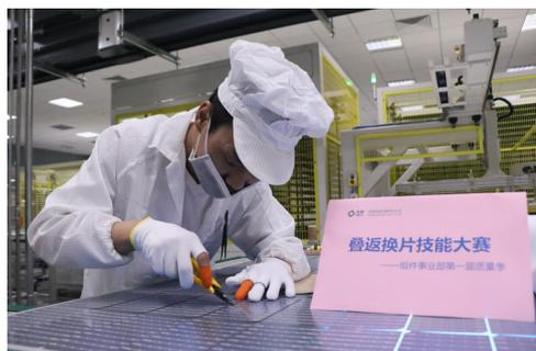
竞赛活动一经发出，一、二车间叠返岗位员工踊跃报名，参赛人数达77名。赛前，参赛选手需准备电池片、垫布和焊枪等工具。根据裁判指令，将指定位置的不良电池片取下并用电烙铁焊接上新的电池片，焊接完毕且自检焊接质量后便整理好现场工具，并将后膜及背板恢复原状。选手示意完成，比赛计时结束。以赛促学，以学提质，经过激烈角逐，依据公平、公正、公开的原则，共评选出一等奖1名、二等奖2名、三等奖3名。
